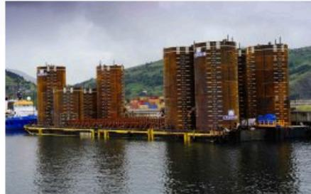
La operativa se ha llevado a cabo en los muelles de La Ría de Bilbao primero. Por su parte, las cadenas que forman parte de la carga han sido construidas por Vicinay Cadenas y las ocho anclas de succión por Navace. En este sentido, seis de las anclas de succión embarcadas tienen 9,5 metros de diámetro y 20 metros de longitud, y las otras dos miden 14 metros.
