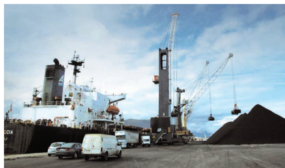
La descarga del carbón se realiza a un ritmo de 30.000 toneladas diarias. Foto J.P.
