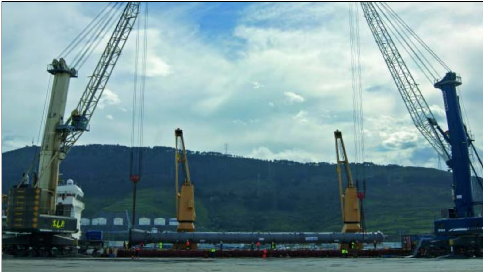
Carga de una de las piezas mediante dos grúas en tándem
